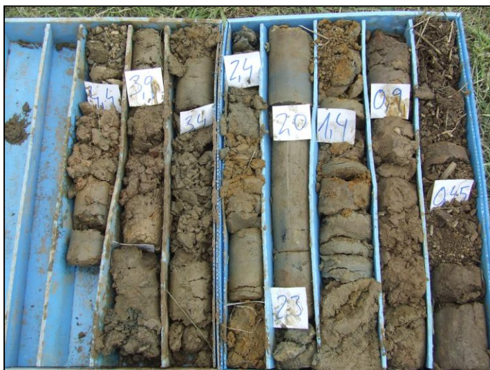
Foto2. Testimoni continu extret del sondeig S-1.
