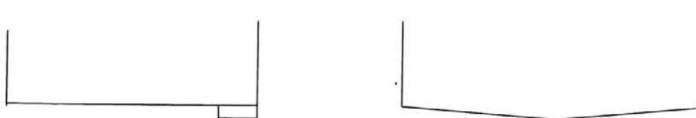
Imatges 4 i 5 . Arqueta cega al terra del contenidor i terra en pendent cap el mig
