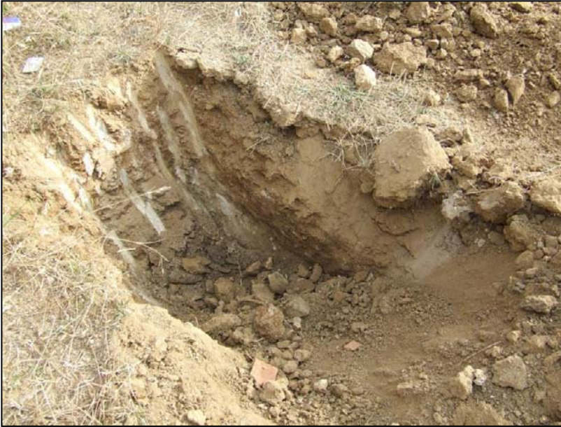
Foto 4. Interior de cala n°3 amb 20cm de rebliment.
