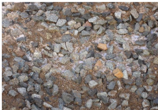
Materials després de l'aportació inicial d'aigua abans de la mescla.
