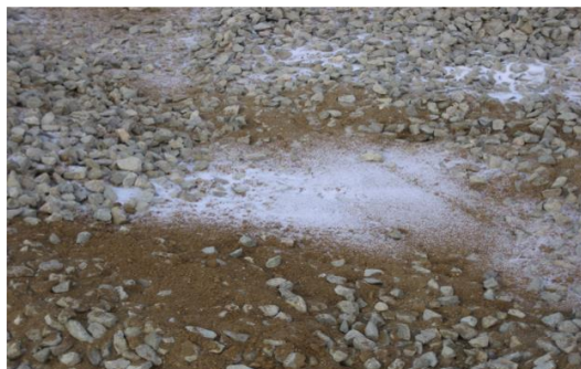
Detall de les partícules de l'hidrogel
