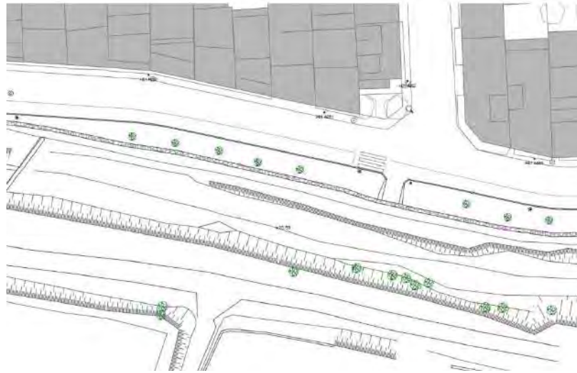
Figura 4. Plànol xarxa enllumenat públic existent
