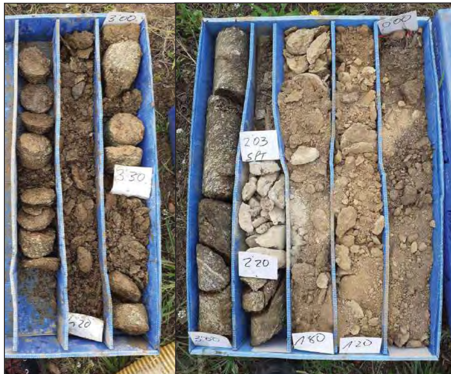
Foto 6. Testimoni extret del sondeig S-2.
