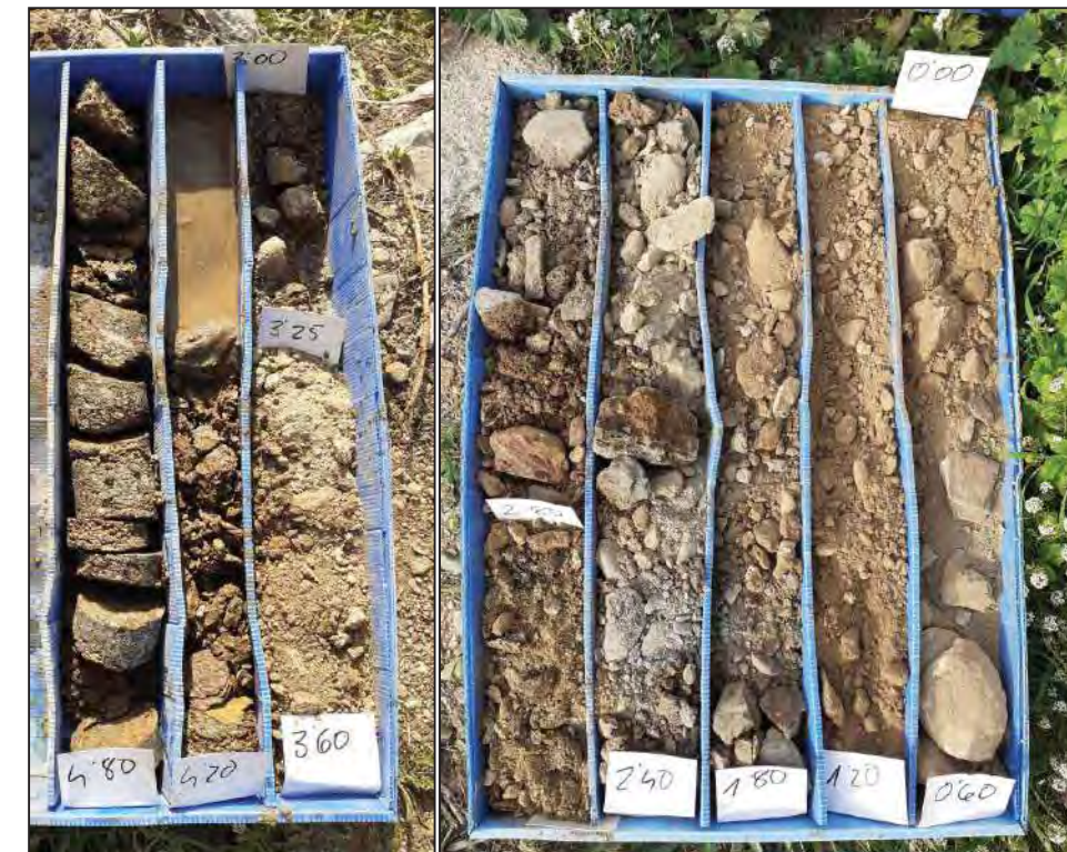
Foto 3. Testimoni extret del sondeig S-1.
