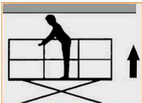
Fig. 4 Choques contra objetos fijos en la fase de elevación de la plataforma
