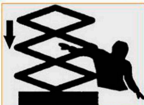
Fig. 6 Atrapamiento de extremidades superiores en la estructura extensible
