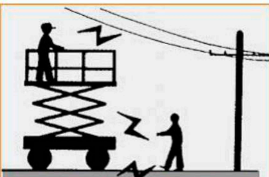
Fig. 5 Contacto eléctrico directo con líneas eléctricas aéreas de AT
