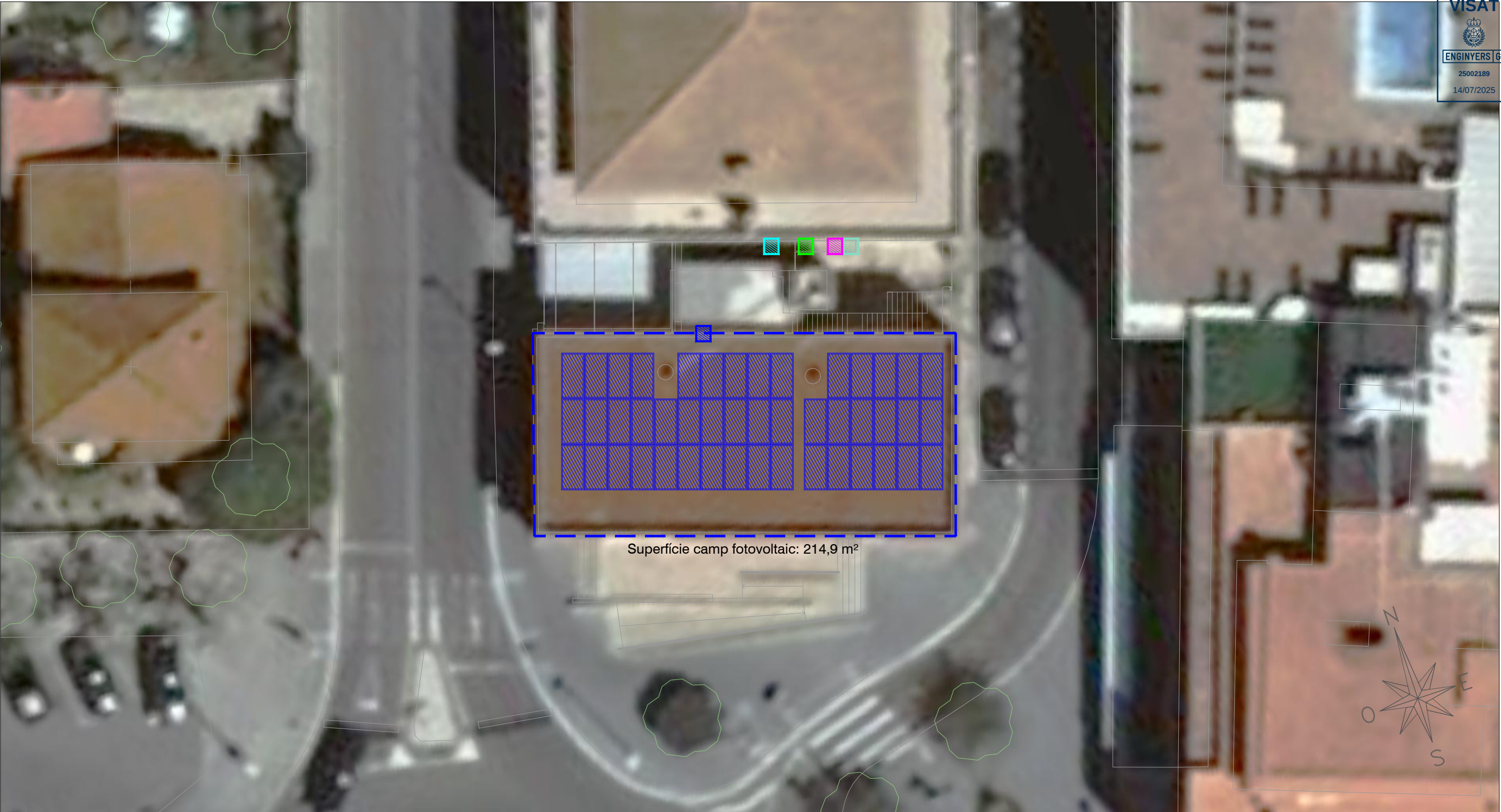
Vista general planta fotovoltaica (esc 1/200).
