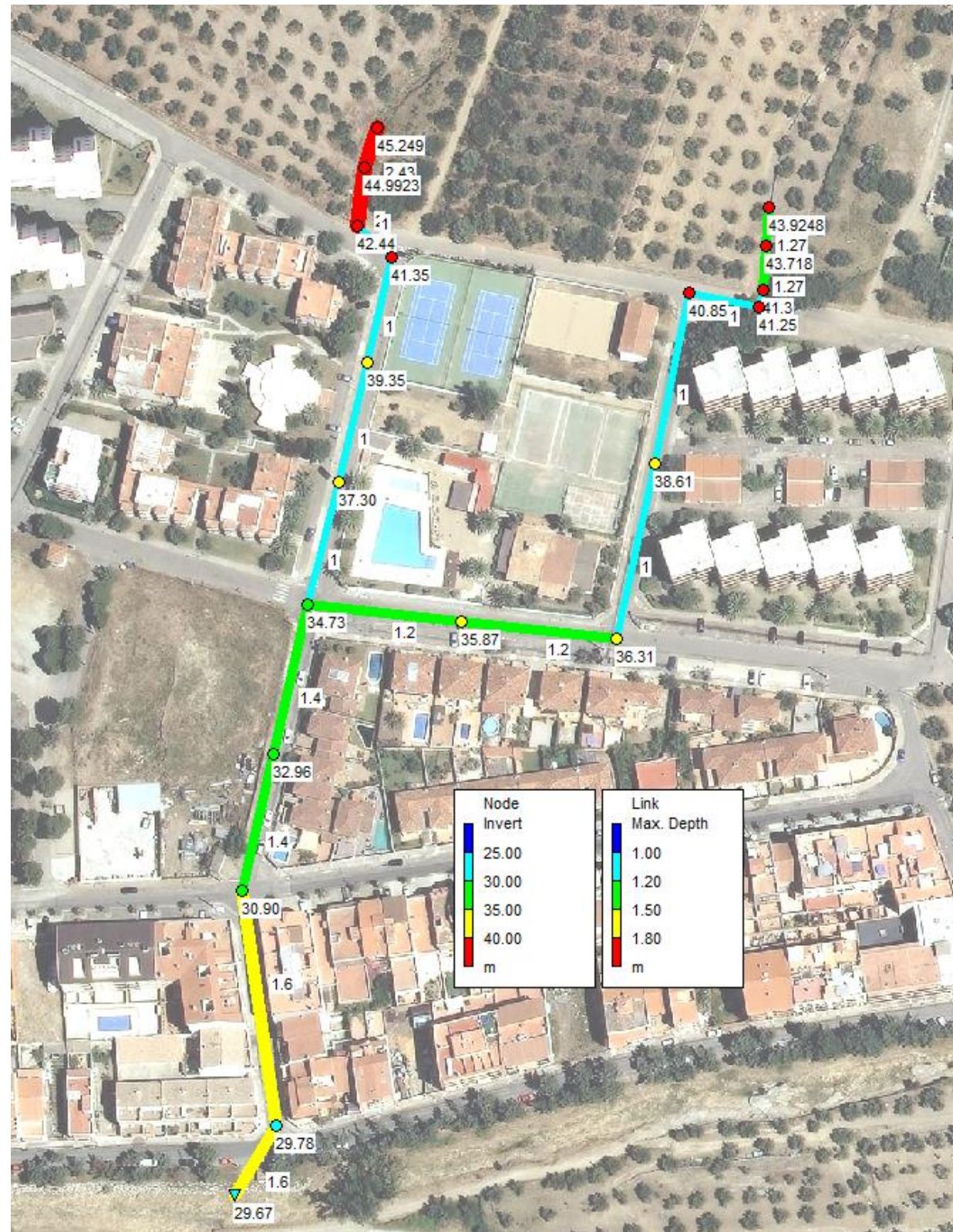
Cota fons de pou i alçada màxima conductes (diàmetre en cas de col·lectors i alçada marges en cas de lleres)
