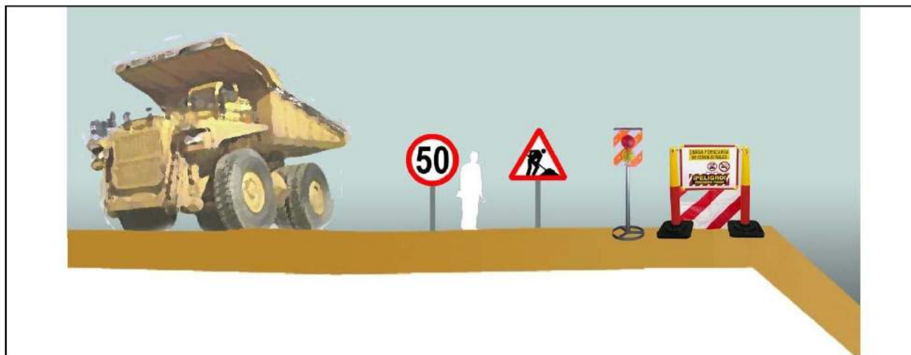
Esquema protecció i senyalització de desmuntats i terraplens
