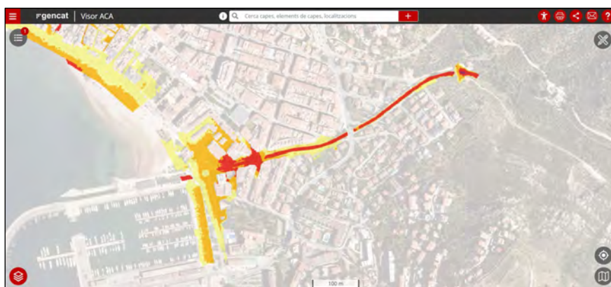
Figura 1. Calats d'inundació (Q500) de la riera de la Quana (MAPRI 2019, visor ACA)
