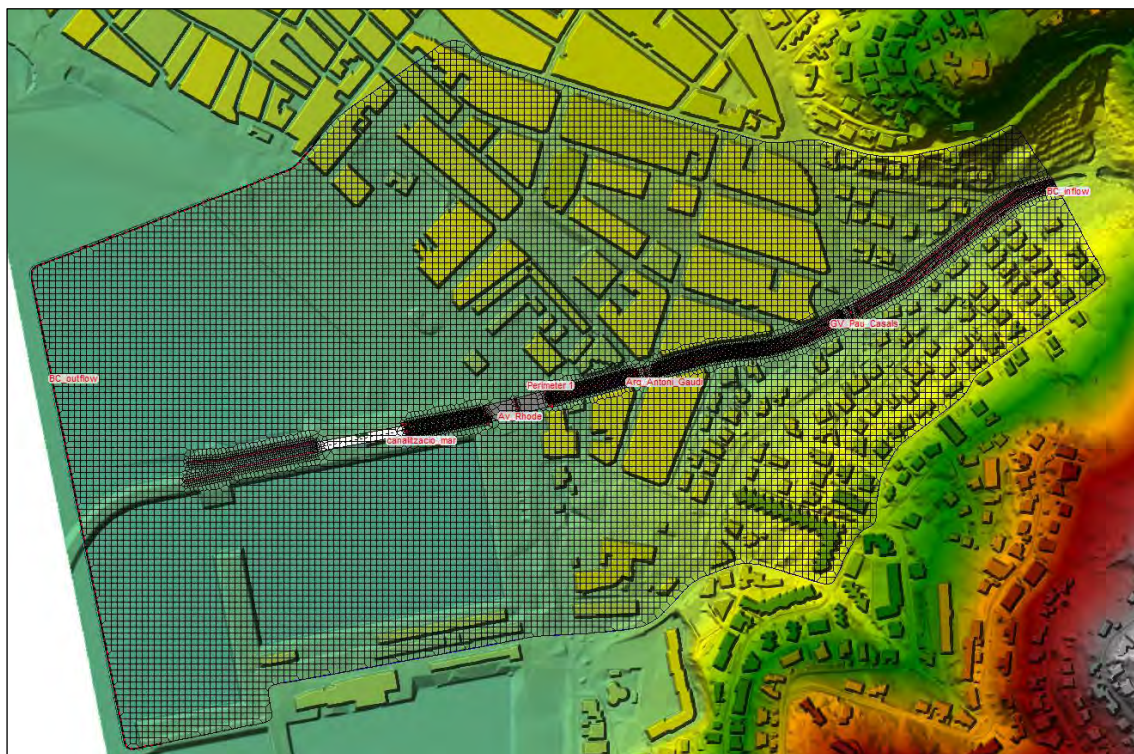
Figura 14. Esquema de la discretització del model hidràulic 2D amb el software HEC-RAS v6.3.1
