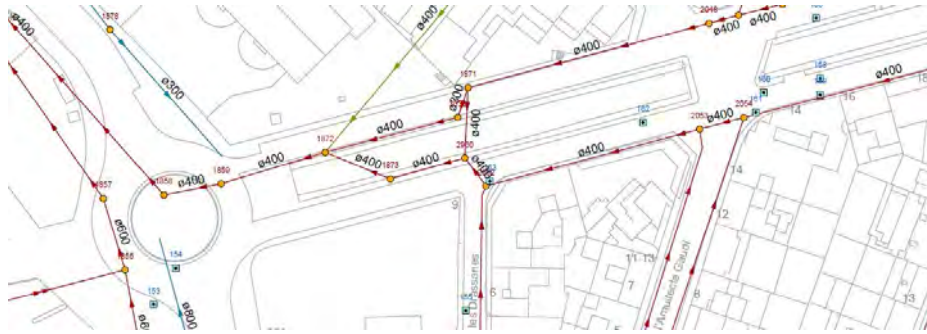
Figura 10. Vista xarxa de clavegueram afectada aigües amunt de l'Avinguda Rhode
