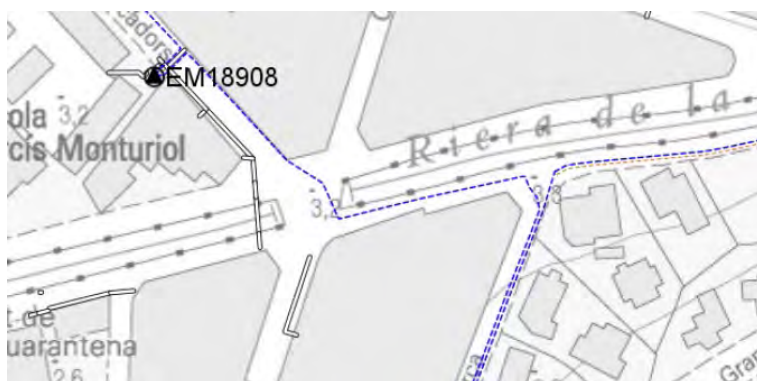
Figura 1. Detall línies elèctriques subterrànies MT afectades
