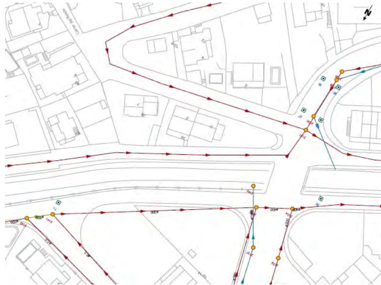
Figura 11. Vista xarxa de clavegueram afectada al pont de la Gran Via de Pau Casals
