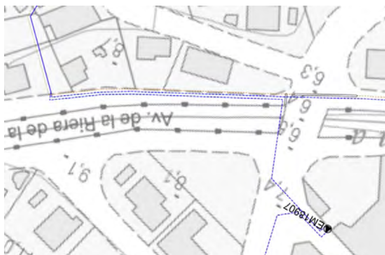
Figura 3. Detall línies elèctriques subterrànies MT afectades
