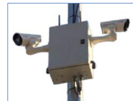
Il·lustració 7. Exemple d'unitat de lectura de matrícules amb dues carcasses
