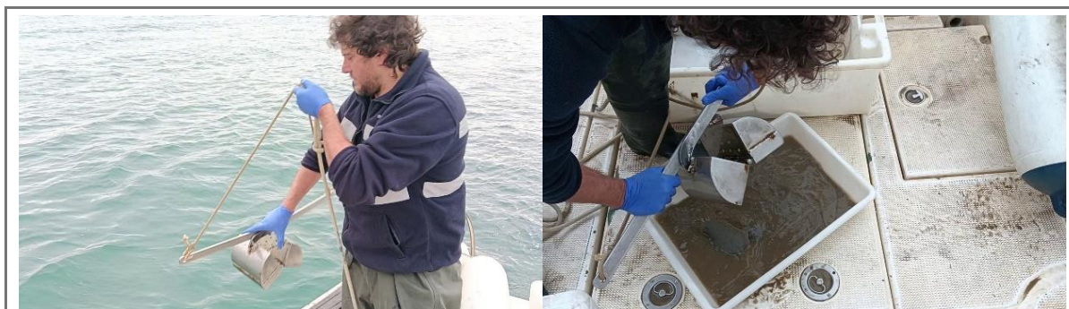
Figura 6.- Presa de mostres superficials amb draga tipus Van Veen.
