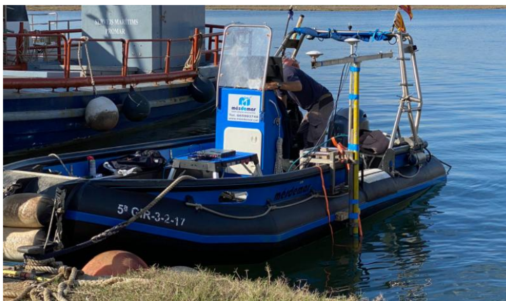
Figura 5 Montaje de la MBES en la embarcación.
