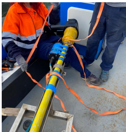
Figura 4 Montaje de la cabeza de la ecosonda multihaz e IMU.
